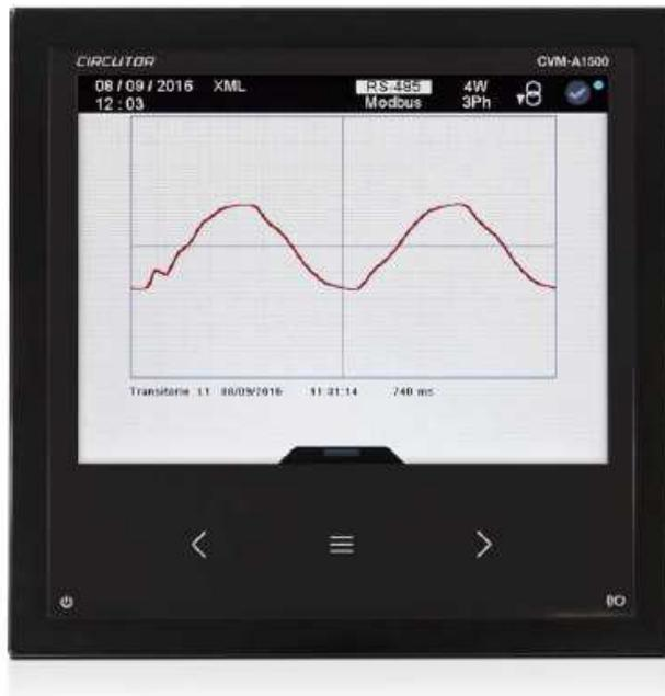
El analizador captura la forma de onda de tensión y corriente al detectar eventos de calidad o deformación de la onda de tensión, almacenándolas de forma interna para su análisis vía web o descargando los datos a **PowerStudio**.
